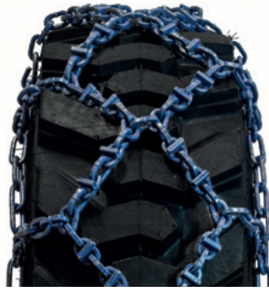
ATV 5.7 mm Nastaton yleisketju lumeen ja jäisille pinnoille.
